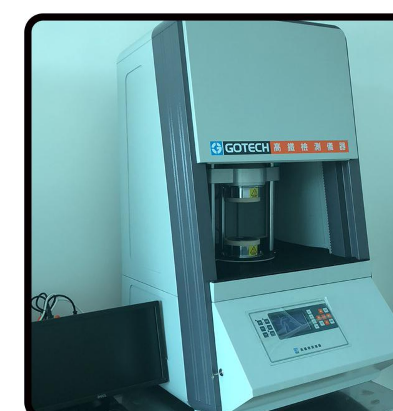
MOVING DIE RHEOMETER
